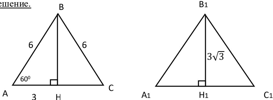
Рассмотрим треугольник ABC. Проведем высоту BH, так как в правильном треугольнике высота является и медианой, то  $AH = HC = 3$  см. Все углы в правильном треугольнике равны  $60^\circ$ . Рассмотрим треугольник ABH. Вычислим высоту BH.  $BH = AH \operatorname{tg} 60^\circ = 3\sqrt{3}$  см. Так как треугольник ABC правильный, то все три высоты равны между собой, а также они равны высотам треугольника  $A_1B_1C_1$ .
