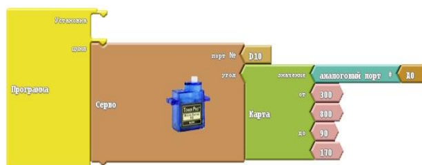
Рис.22 – Программа для поворота поворота умных жалюзи с постоянными значениями
