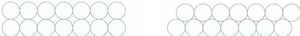
**Рисунок 1.7 - Квадратная и шестиугольная упаковка в два слоя в двумерном пространстве**
